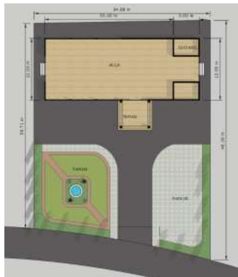
Gambar 3. Denah balai RW hasil pengembangan
